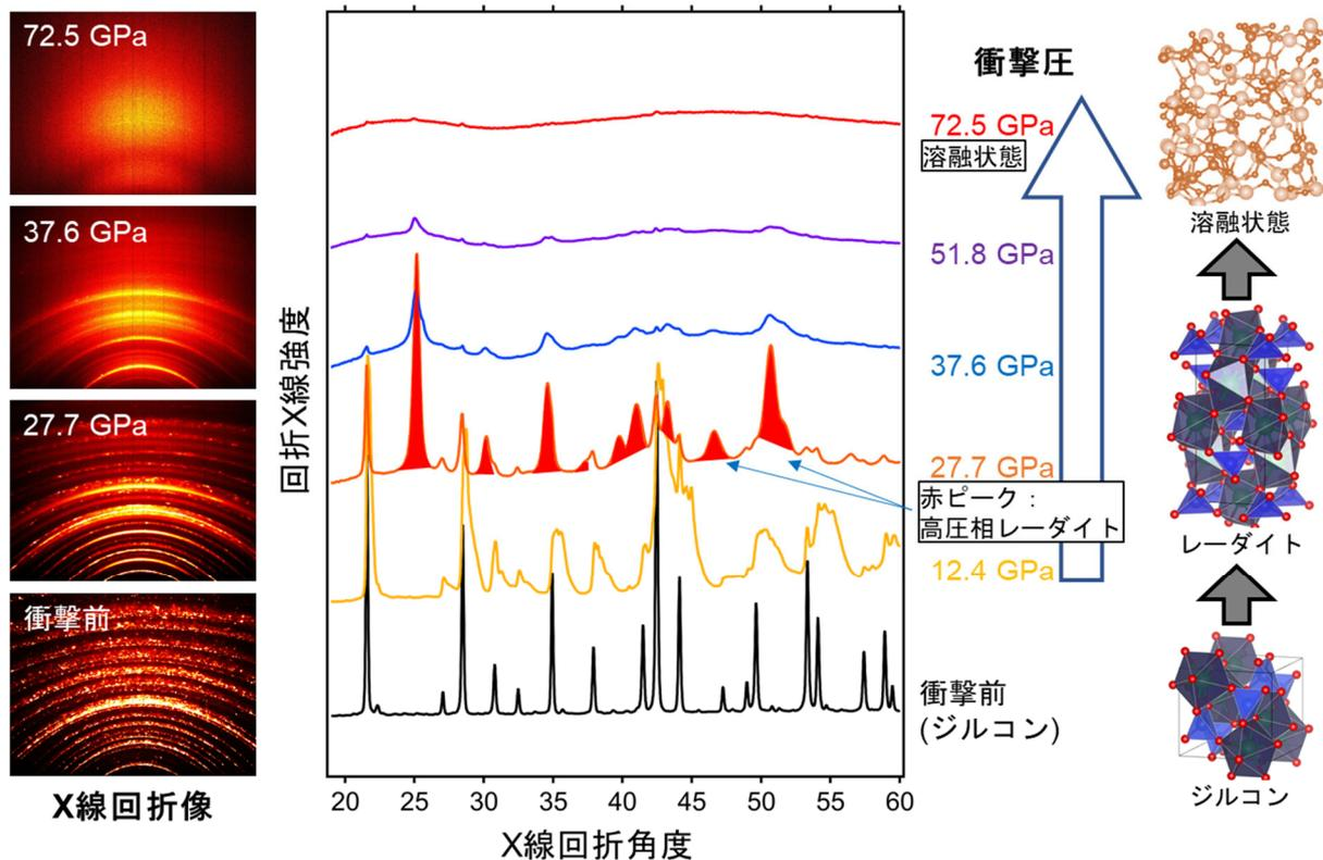
図2 高強度レーザーパルスのエネルギーごとのX線回折スペクトル変化。照射エネルギーの増加に伴いより強い衝撃状態が発生される。27.7GPaで高压相レーダイトが見られるようになり、72.5GPaで溶融状態に変化した。
