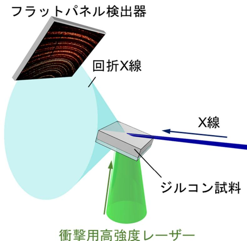
図1 レーザー衝撃圧縮実験の概略図
